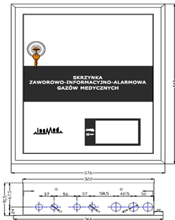
Rys. 1. Skrzynka zaworowo-informacyjno-alarmowa dla jednego, dwóch lub trzech gazów SZIAN-1/, SZIAN-2/, SZIAN-3
