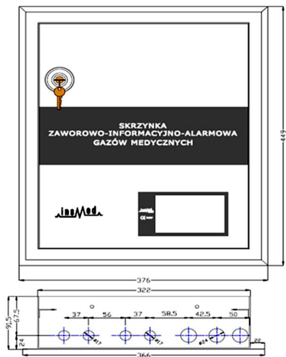
Rys. 3. Skrzynka zaworowo-informacyjno-alarmowa dla jednego, pięciu i sześciu gazów SZIAN-5/SZIAN-6
